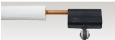
矯正工具で、管端の楕円矯正を行います。矯正工具と管端面を合わせた状態で、管の周方向に2~3回工具の場所を変え矯正を行ってください。(管の曲がりを矯正する工具ではありません)
