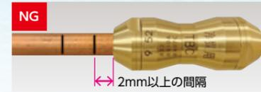
第1標線と継手端面に2mm以上の間隔がある場合、挿入不足です。さらに差し込んでください。
