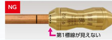
第1標線が継手内部まで入り見えない場合、マーキング時に管端が標線ゲージの奥に当たっていない状態でマーキングされた可能性があります。管寸法が許容範囲外であったり、湾曲している管に継手を無理矢理差し込んだことが考えられ施工が正しくされていないことから、漏れにつながる恐れがあるため、新品の継手を用いて施工をやり直してください。
