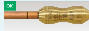
第1標線と継手端面が一致していれば、正常に接続されています。
