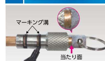
専用の標線ゲージに管を通し、指定の油性マジックで標線2本をマーキングしてください。
